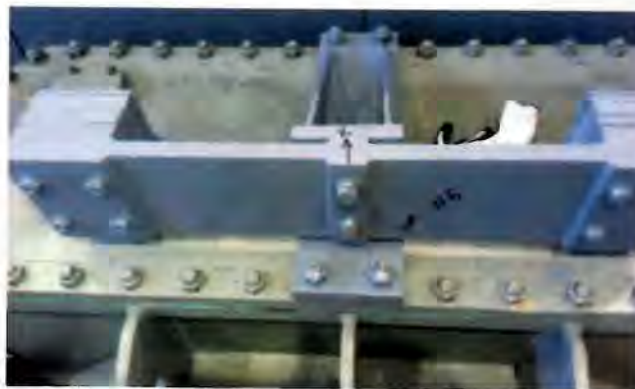
Рис. 2. Динамический виброгаситель балочного типа
