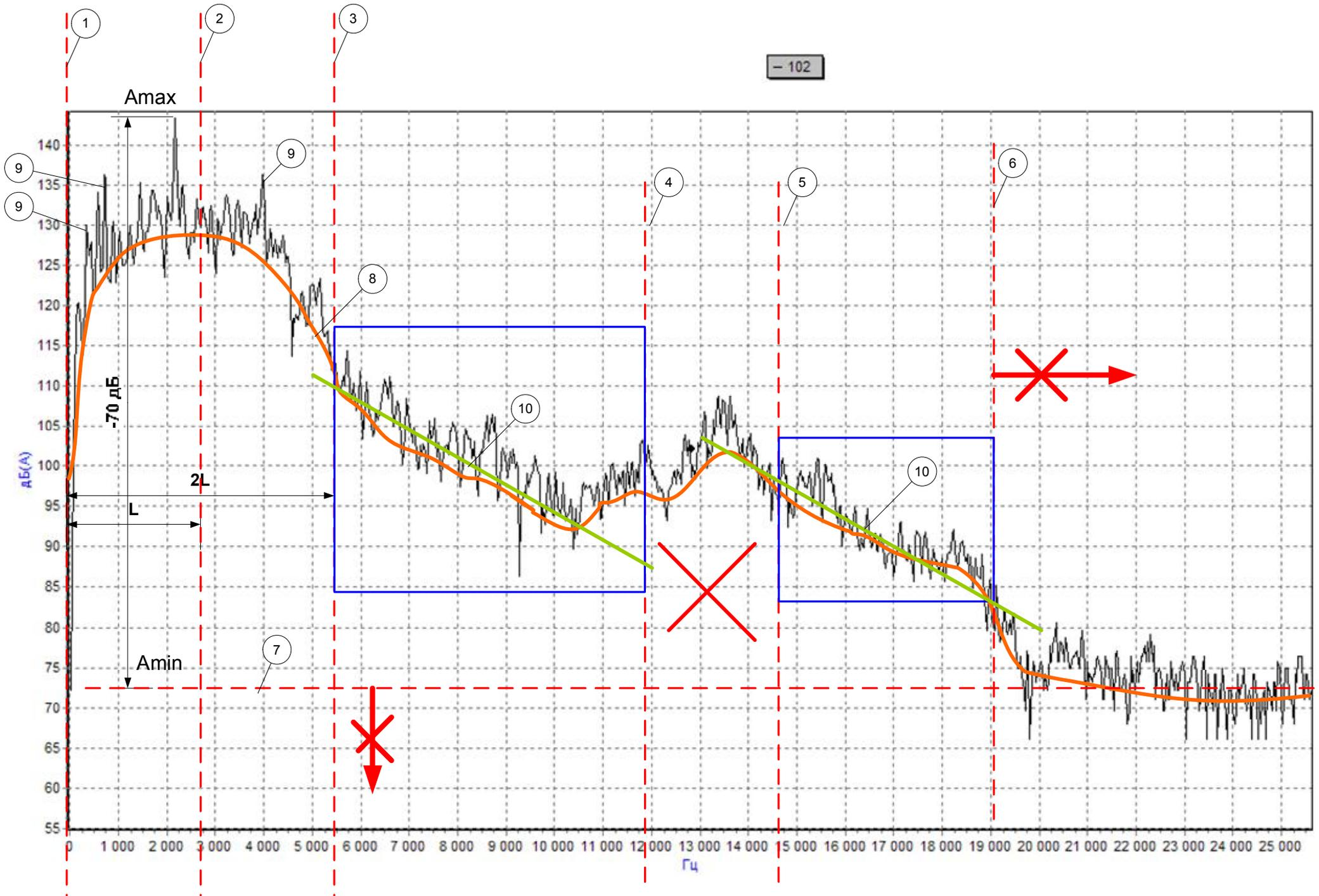
1. Измеряем спектр с контрольной точки на 25 600 Гц (в некоторых случаях можно использовать спектр 12 800 Гц).
