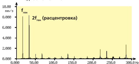
Генератор, приводной подшипник, исходное состояние
